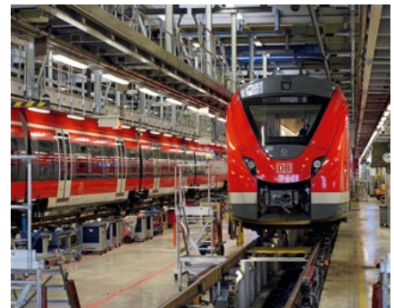
DB Regio AG – Werk Nürnberg – Instandhaltungsarbeiten an einem Triebwagen der Baureihe ET 1442 der S-Bahn Nürnberg
