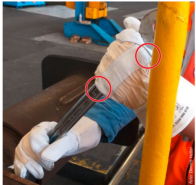
Fehlender Anstoßschutz beim Handschuh
