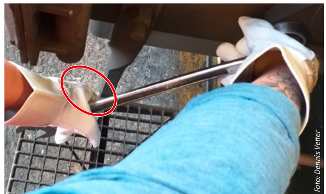
Fehlender Anstoßschutz beim Handschuh
