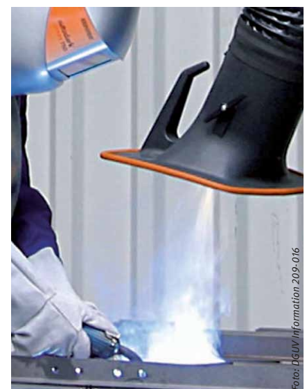
Abbildung 2: Metallschutzgasschweißen mit Absaugung
