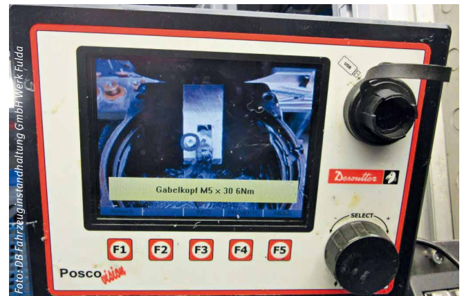
Abbildung 7: Anhand der Anzeige wird genau vorgegeben, welcher Schraubvorgang vorgenommen werden muss
