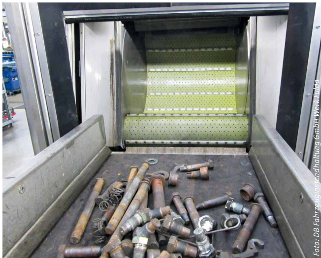
Abbildung 9: Handarmbelastungen und Verletzungen, die früher auftreten konnten, werden mit der Strahlanlage vermieden
