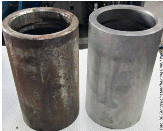
Abbildung 10: Kleinteil links vor der Reinigung und rechts nach der Reinigung mit der Strahlanlage
