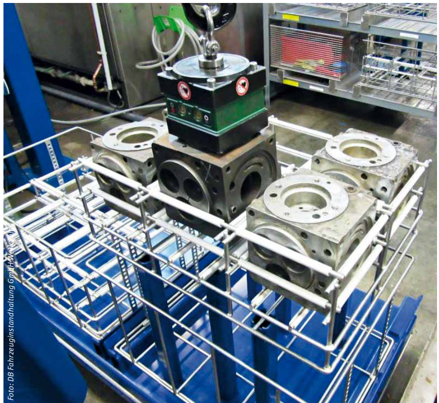
Abbildung 1: Der aus Gusseisen bestehende Grundkörper wird mittels des magnetbetriebenen Balancers in den speziellen Waschkorb abgelegt
