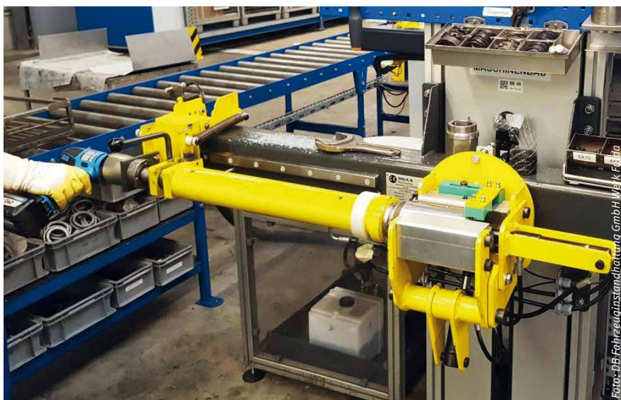
Abbildung 11: Individuell verstellbare Vorrichtung zur De- und Montage von Bremsgestängestellern
