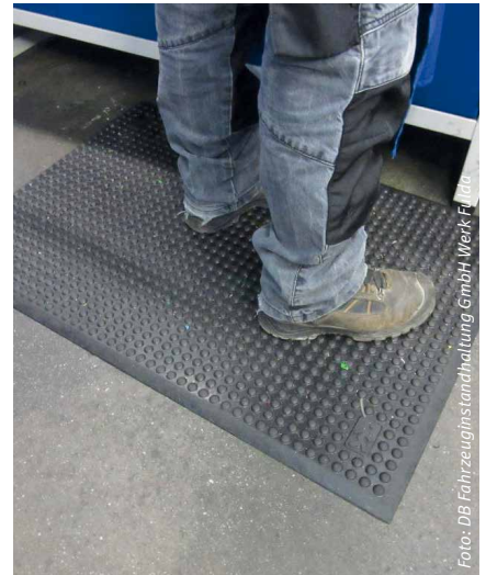
Abbildung 5: Zur Entlastung der Kniegelenke, Bandscheiben und Wirbelsäule sind die Arbeitsstände mit Anti-Ermüdungsmatten ausgestattet
