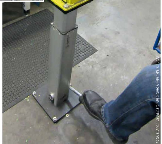
Abbildung 4: Mittels Handhebel kann das auf der Hubsäule befestigte KE-Steuerventil geneigt und gedreht werden
