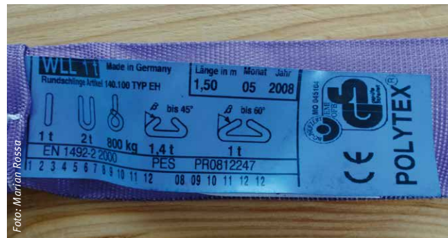
Abbildung 3: Blaues Etikett nach DIN EN 1492 Teil 2 für eine Rundschlinge aus Polyester (PES)
