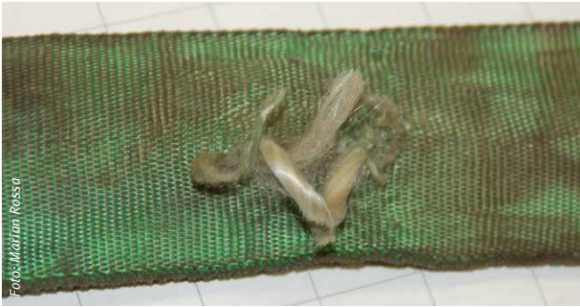
Abbildung 8: Beschädigung, die das tragende Garnelege zerstört und freilegt
