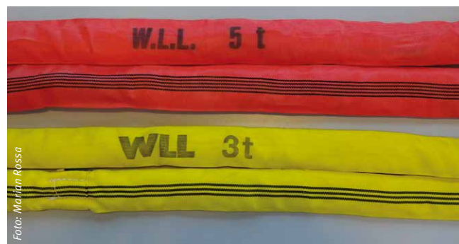
Abbildung 4: Farbkennzeichnung von Rundschlingen für die Tragfähigkeit 5 t (rot) und 3 t (gelb), zusätzlich mit Tragfähigkeitsangabe (in Anschlagart direkt) und Tonnenstreifen
