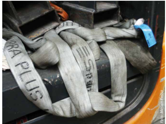
Abbildung 5: Rundsclingen werden unsachgemäß unter Stahlprofilen aufbewahrt. Sie sind der Benutzung zu entziehen und müssen überprüft werden
