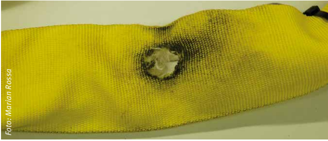
Abbildung 7: Beschädigung der Rundschnur durch Hitze
