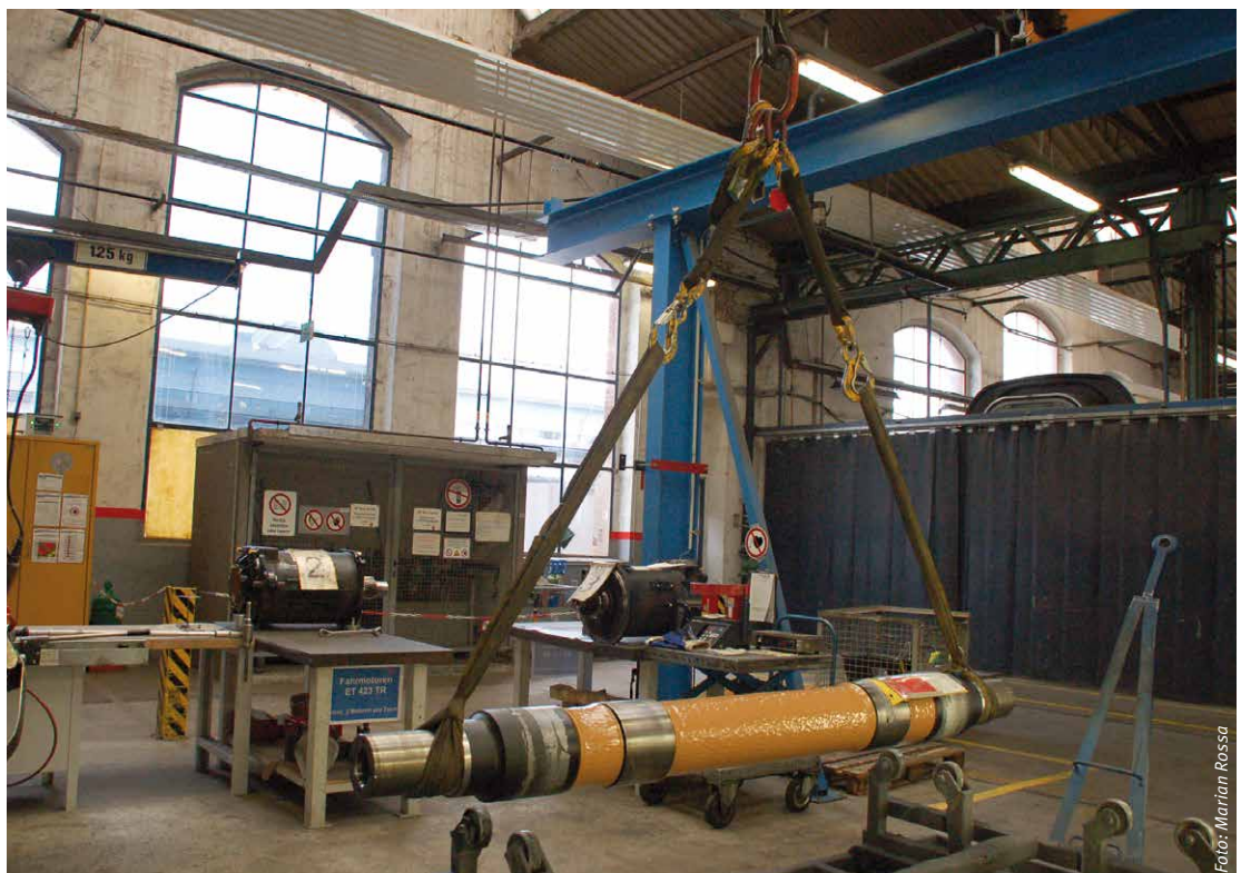
Abbildung 1: Rundschlingengehänge kombiniert mit Rundschlingen, die im Schnürgang angeschlagen sind
