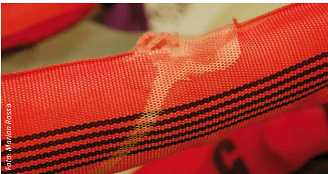
Abbildung 9: Beschädigung der Ummantelung durch aggressive Chemikalie
