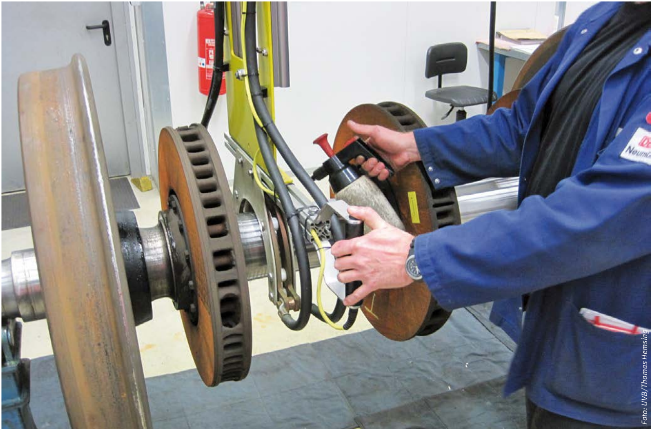
Aufsprühen der magnetisierbaren Flüssigkeit auf die Radsatzwelle
