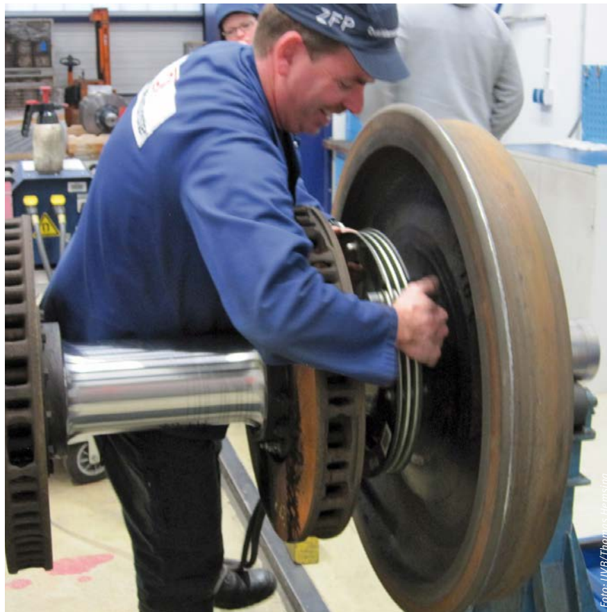
Abbildung 3: Altes Verfahren – manuelles Aufsetzen der Klappspule zwischen Brems-scheibe und Radscheibe
