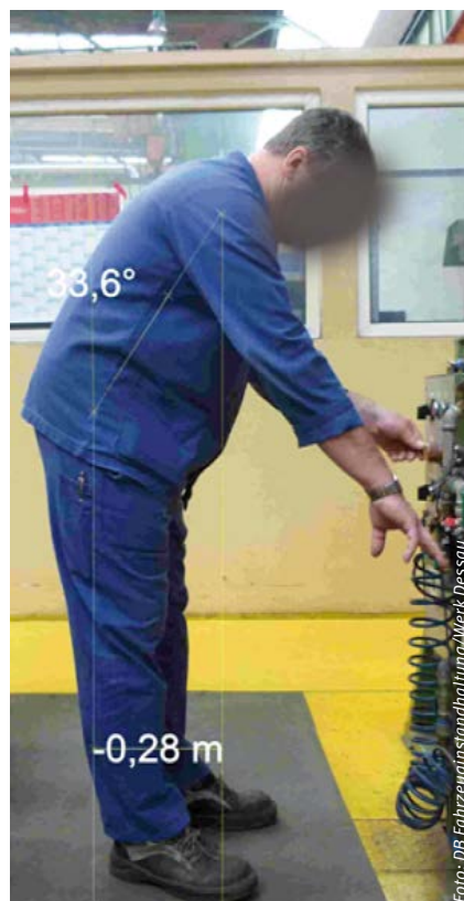
Abbildung 7: Verbesserung der Arbeitsbedingung durch eine Stehhilfe
