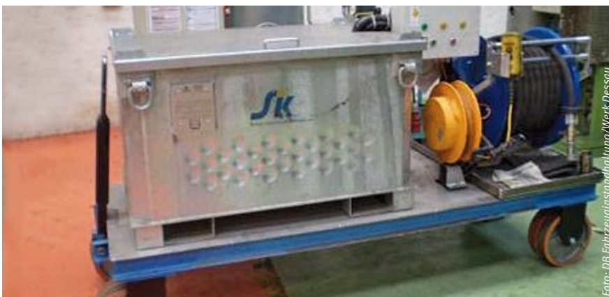
Abbildung 5: Ölauffangwagen (manuelle Betätigung)
