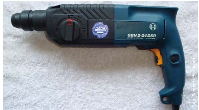
Abbildung 2: Arbeitsmittel Bohrmaschine mit Prüfplakette
