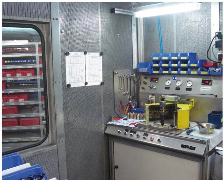
Abbildung 5: Sicherheitsventilprüfstand in der Schallschutzkabine
