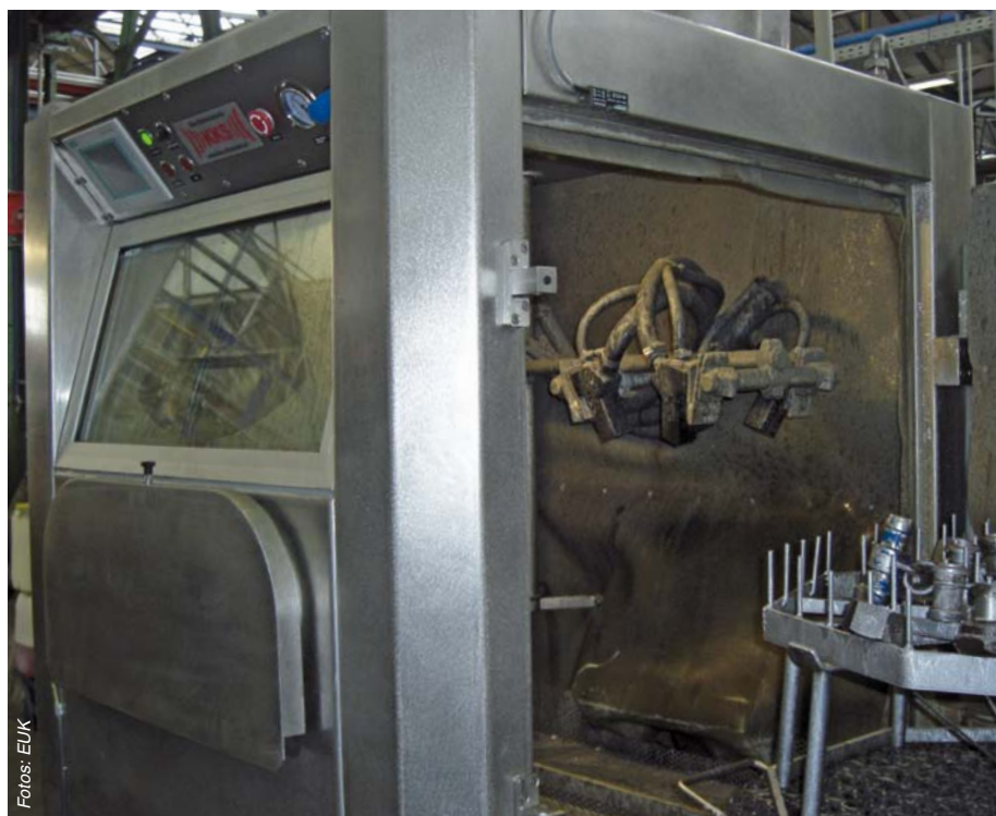
Abbildung 2: Gekapselte Glasperlenstrahlanlage für die Reinigung von Schlauchkupplungen
