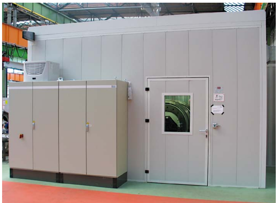
Abbildung 8: Lärmschutzkabine (Einhausung) für Antriebslaufstand
