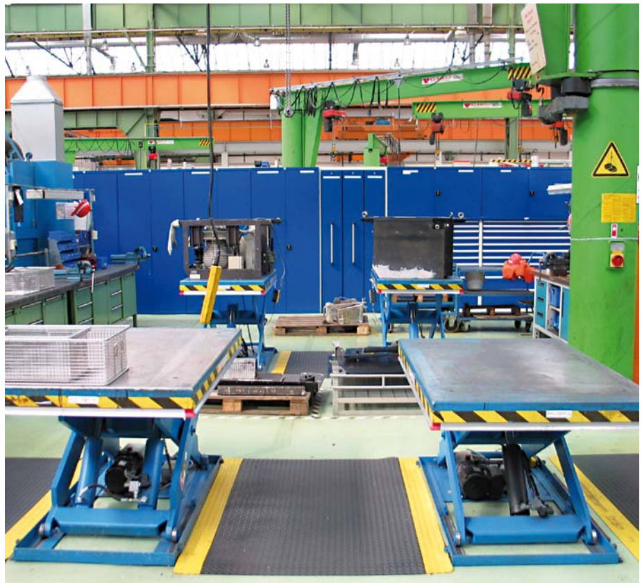
Abbildung 7: Arbeitsplatzmatten (so genannte Anti-Ermüdungsmatten) für Steharbeitsplätze
