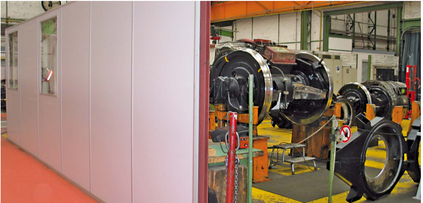
Abbildung 9: Schallschutzwand neben Laufstand für Fahrmotor mit Radsatz
