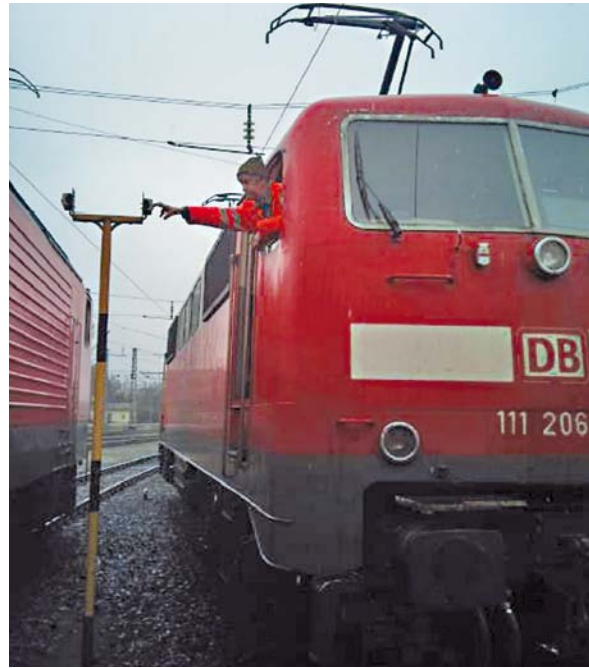
Abbildungen 3 und 4: Negativbeispiele – Erreichbarkeit des Schlagtaster nur unter unergonomischer Körperhaltung möglich
