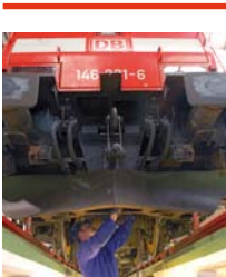
Unser Titelbild: Einstellen des Schneeräumers an einer E-Lok der BR 146 im Werk Dessau der DB Fahrzeuginstandhaltung GmbH.
