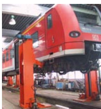
Unser Titelbild: Damit Schienenfahrzeuge sicher angehoben werden können, ist bei Hebebockanlagen Präzision gefragt.
