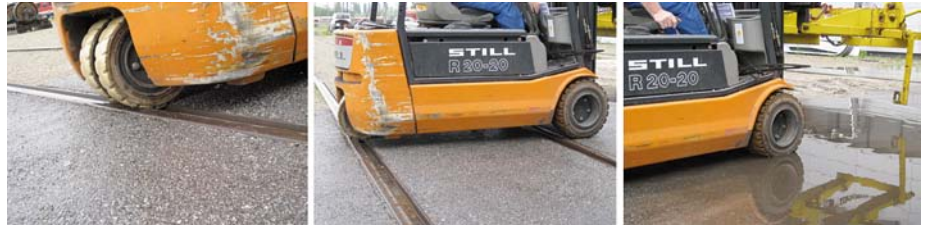
Abbildung 1: Stapler auf einer Schiene mit Spurrille, witterungsbedingte Erschwernisse durch Regen
