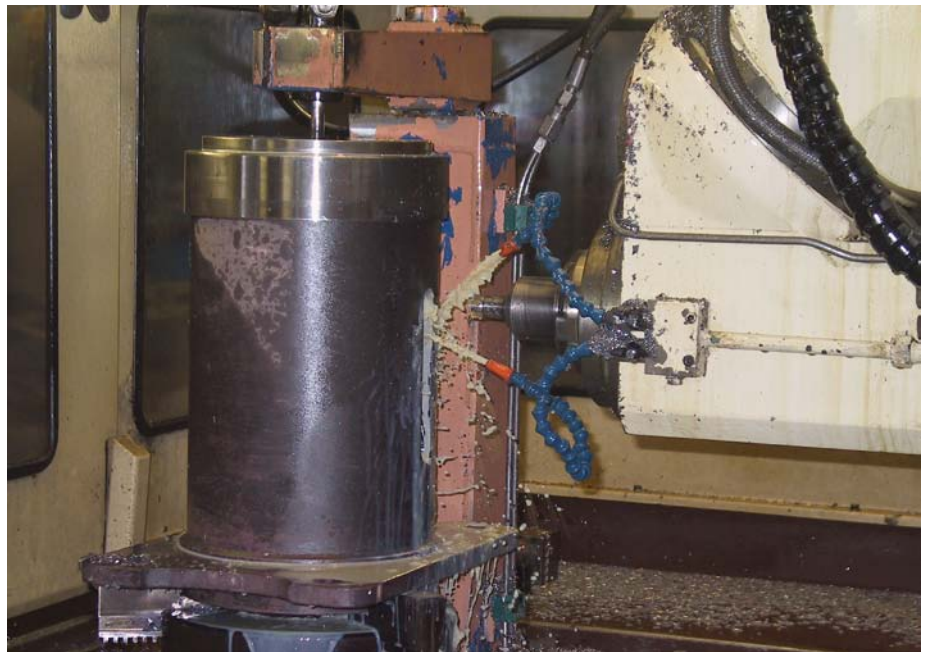
Nassbearbeitung von Metall mit wassermischbaren Kühlschmierstoffen (Foto: EUK)
