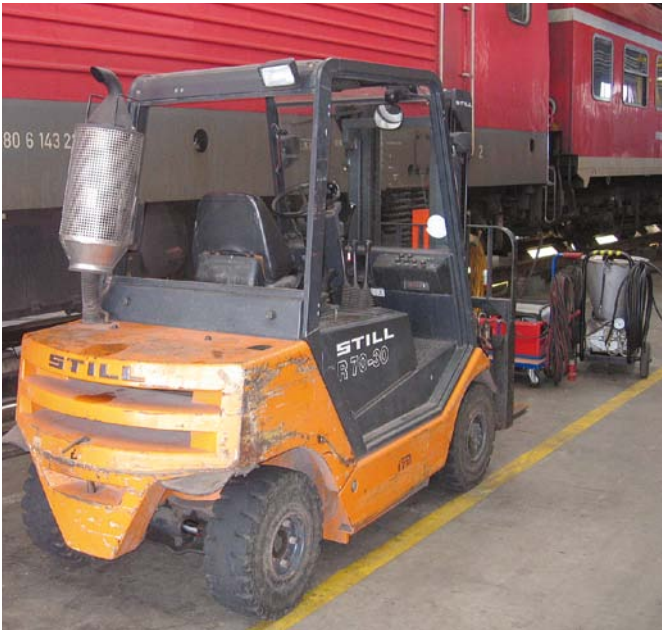
Abbildung 3: Dieselgabelstapler für kurzzeitige Transportvorgänge, ausgerüstet mit DPf.
