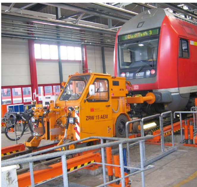
Abbildung 1: Bereitstellung der Fahrzeuge mit Akku-Schleppfahrzeug.
