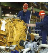
Unser Titelbild: Arbeiten an der flexiblen Kupplung einer Rangierlok der BR 365 im Werk Cottbus.
