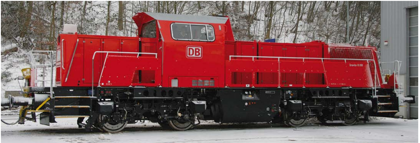
Diesellok Gravita: Neue Baureihe mit Dieselpartikelfilter.
