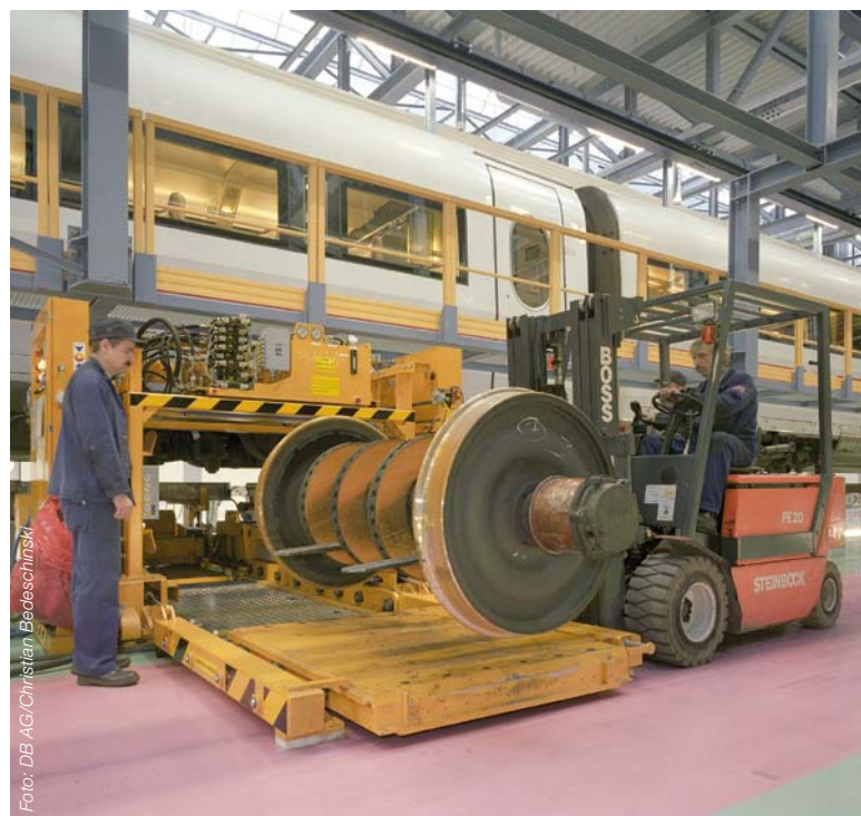
Abbildung 2, unten: Die Bemessung der Verkehrswege für den innerbetrieblichen Transport orientiert sich an dem breitesten Teil, hier dem Transportgut – der Achse, zuzüglich der Sicherheitszuschläge.
