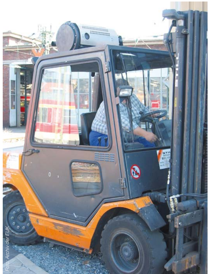
Abbildung 1, oben: Dieselstapler mit Partikelfilter und geschlossener Kabine als Fahrerrückhaltesystem, vorgesehen für den überwiegenden Einsatz im Freien.
