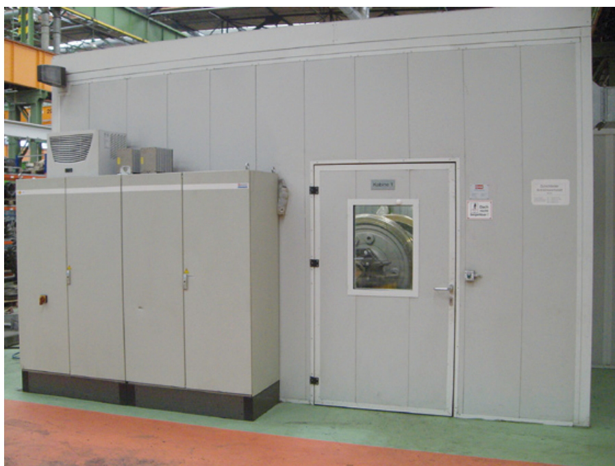
Abbildung 3: Lärmschutz- kabine „Einhausung“ für Antriebs- laufstand.
