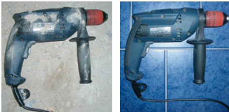
Abbildung 2: Eine Bohrmaschine unter rauen Einsatzbedingungen und hohen Belastungen (links) muss häufiger geprüft werden als eine selten benutzte, die
