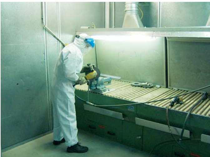
Abbildung 4: Schleifen von Aluminiumkomponenten in einer Kabine.
