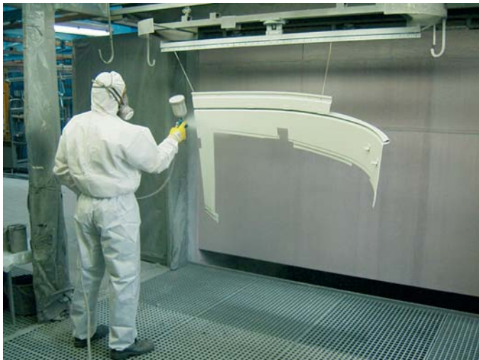
Abbildung 1: Lackierarbeiten in einer Farbspritzkabine.
