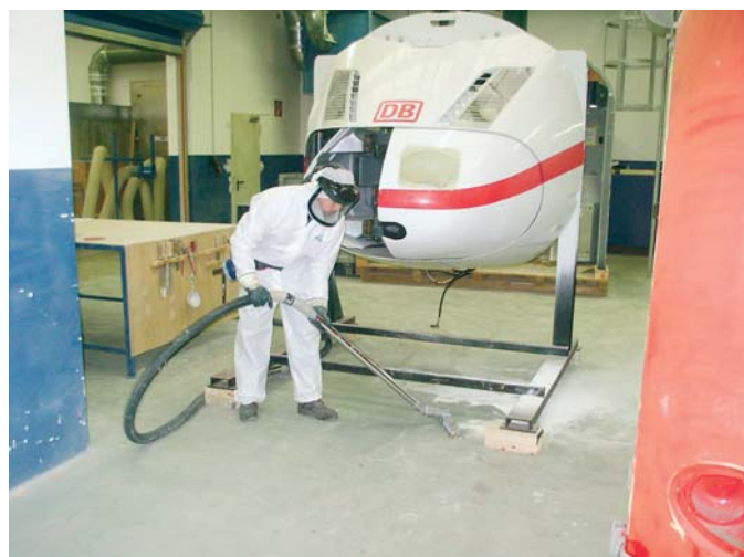
Abbildung 6: Reinigung des Bodenbereichs durch Aufsaugen brennbarer GFK-Stäube.
