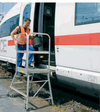
Abbildung 3: Bei Reinigungsarbeiten geringen Umfangs, also ohne den Einsatz von Reinigungsmaschinen und -geräten, können an Stelle der Reinigungsbühnen Einstieghilfen verwendet werden (GUV-I 835).
