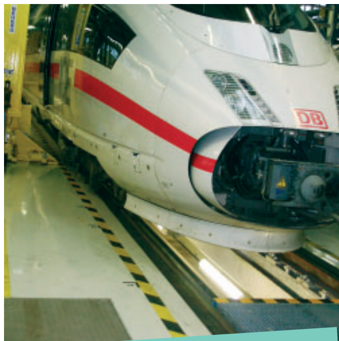
Abbildung 5, unten: Diese Arbeitsgrube ist durch ein Schienenfahrzeug abgedeckt und daher sicher.
