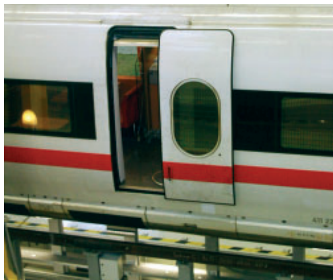
Abbildung 4, oben: Im Bereich von ungesicherten Türen besteht Absturzgefahr.
