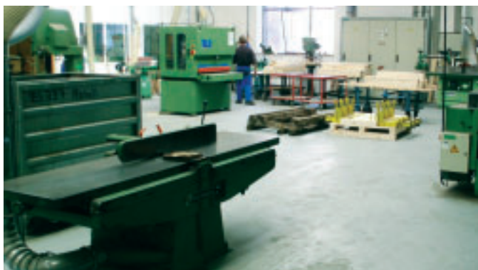
Abbildung 2: In einer Schreinerei. Holzstäube- und Späne können die Gleitreibung des Bodens herabsetzen.
