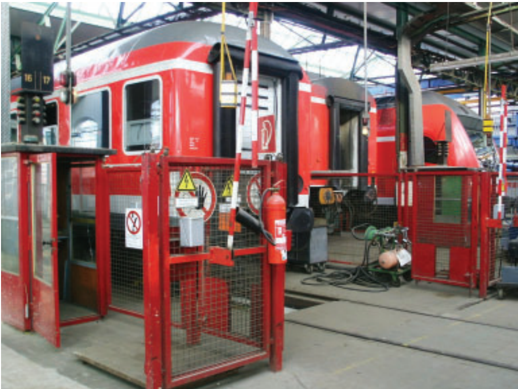
Abbildung 2: Abgeteilte Prüffelder für Einzelfahrzeuge.
