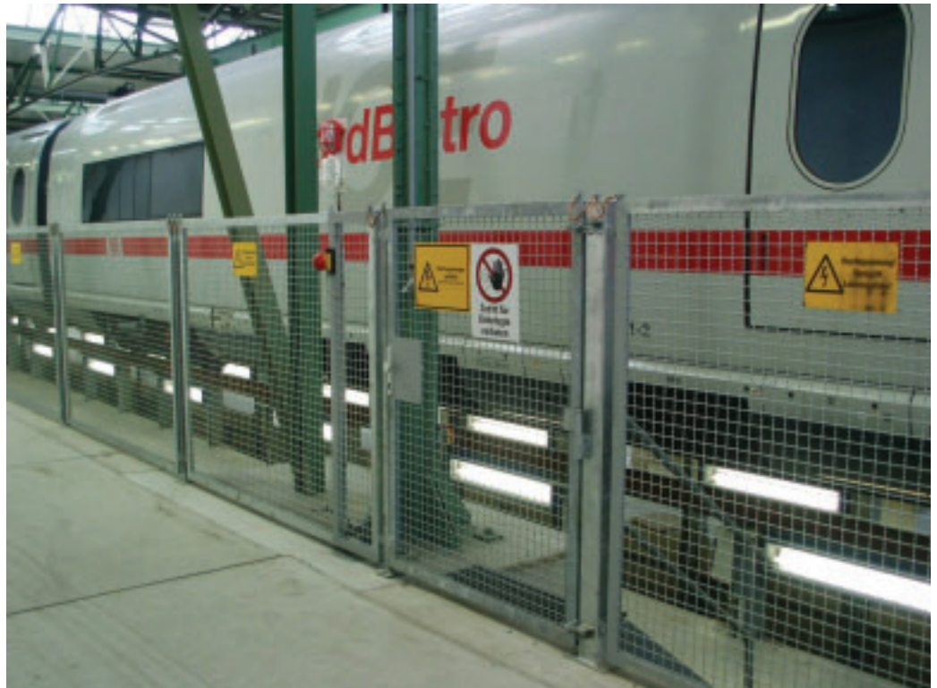
Abbildung 3: Prüffeldanlage für Triebzüge. Die Abgrenzungen zu benachbarten Arbeitsplätzen bestehen hier aus 1800 mm hohen Gitterwänden.
