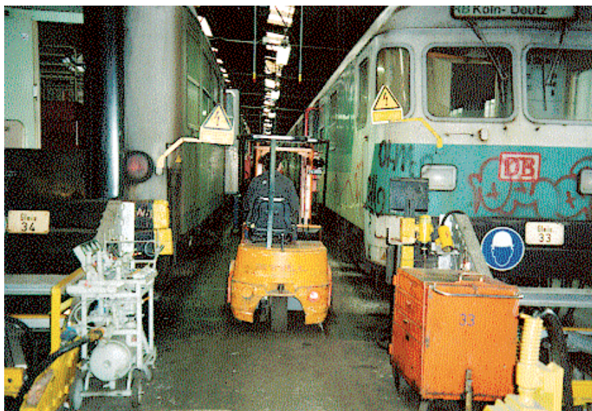
Nicht überall sind die Verkehrswege für kraftbetriebene Flurförderfahrzeuge ausreichend breit.
