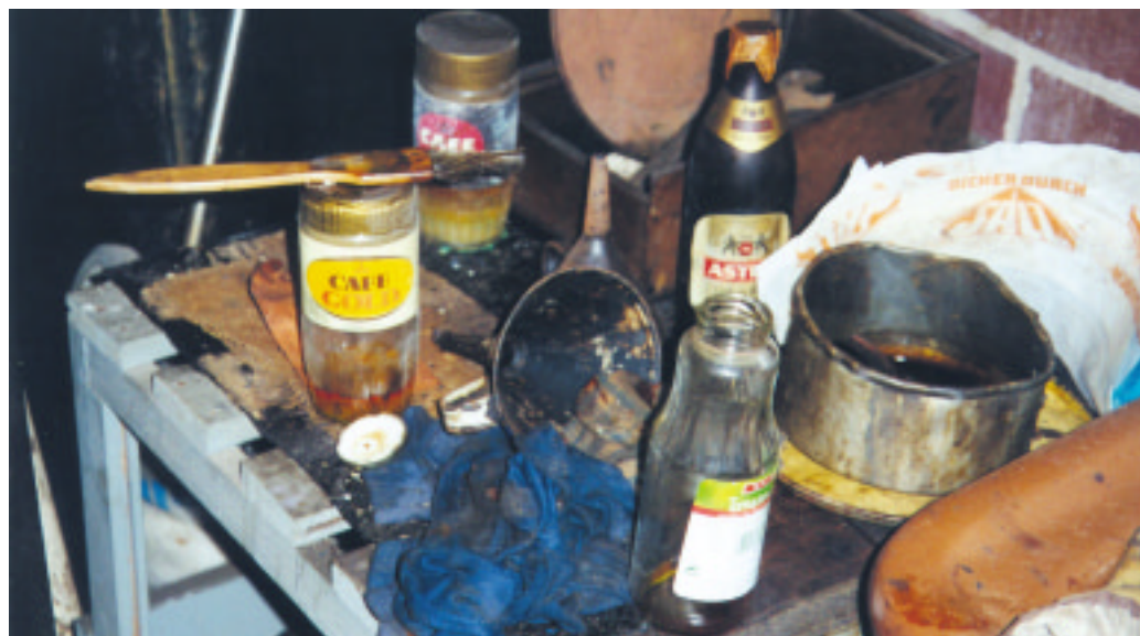
Abbildung 2: Unzulässige Benutzung von Lebensmittelgefäßen zur Aufbewahrung von Gefahrstoffen. Für den Umgang mit Gefahrstoffen stehen geeignete Gefäße in allen erforderlichen Größen und Materialien zur Verfügung.
