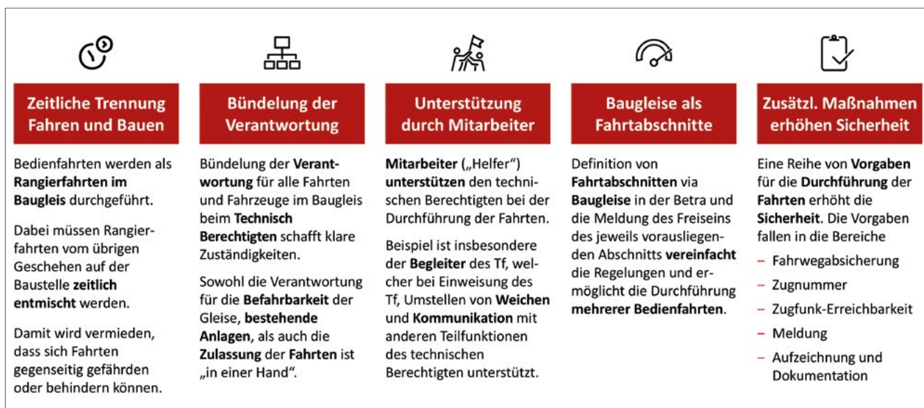
Abbildung 3: Fünf Pfeiler gewährleisten die Sicherheit
