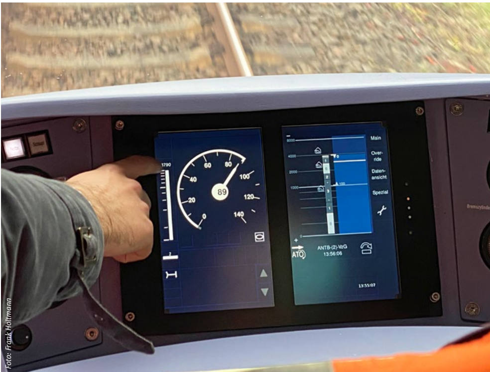
Ansicht des modularen Führerraumdisplays eines mit ETCS und ATO fahrenden Triebzugs BR 474
