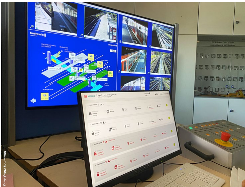
Bedieneinrichtung des „Fern-Tf“ für die vollautomatische Rangierfahrt
