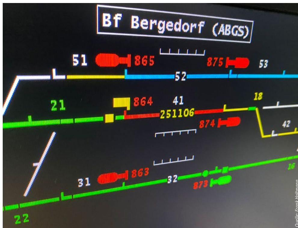
Lupenausschnitt des ESTW „Bfs“ in Hamburg-Bergedorf – das Ausfahrtsignal 864 ist für die Fahrt des 251106 in ETCS L2 dunkelgeschaltet
