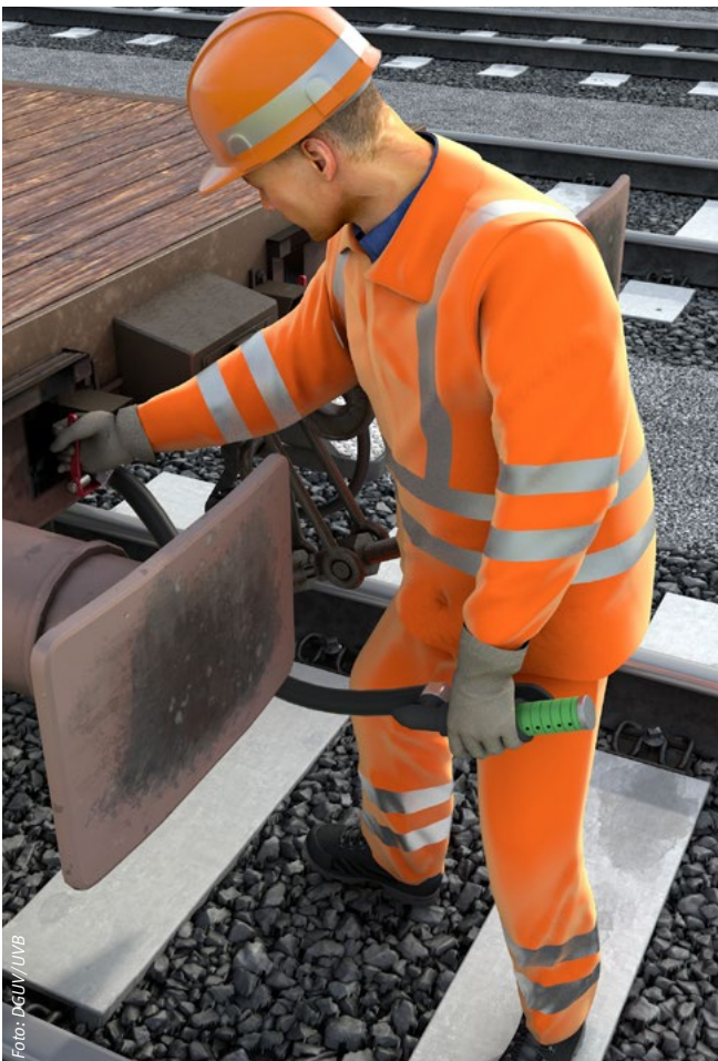
Rangierer beim Durchführen der Bremsprobe mit Schalldämpfer
