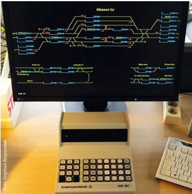
Abbildung 1: Zugnummernmeldeanlage mit Bildschirm
