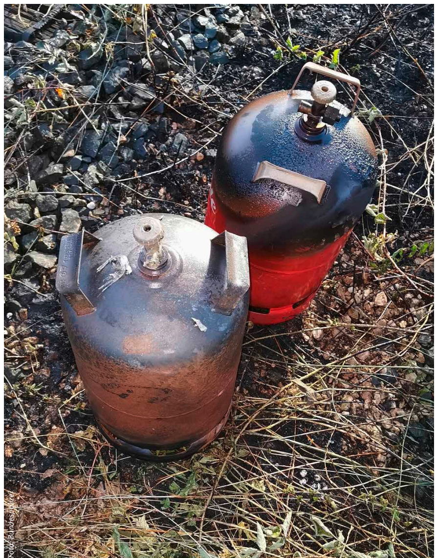
Abbildung 2: Die ausgebrannten Propangas- flaschen nach dem Unfall
