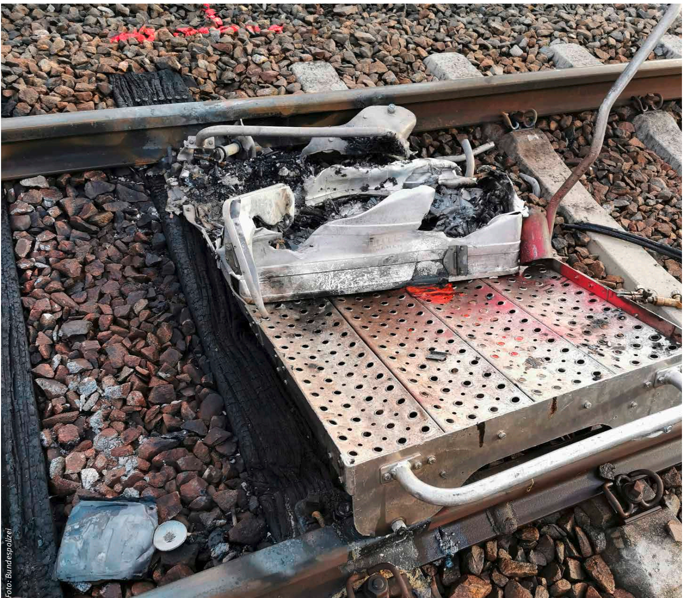
Die Reste eines Flaschen-transportwagens
