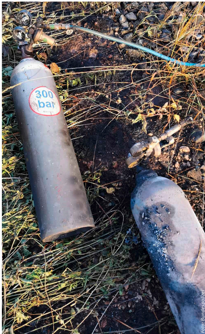
Abbildung 3: Die Sauerstoffflaschen nach dem Unfall
