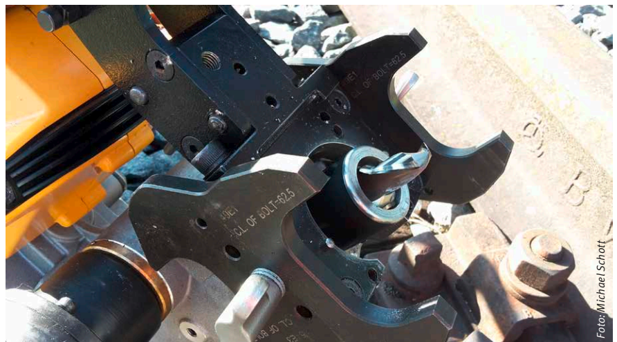
Abbildung 3: Bohrer mit Fase und Adapter in der Schienenbohrmaschine
