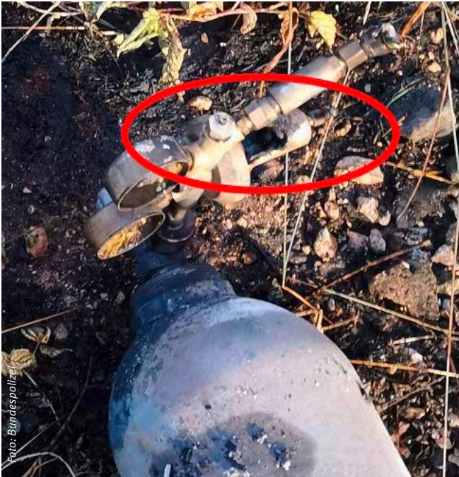
Abbildung 4: Der ausgebrannte Druckminderer an der Sauerstoffflasche
