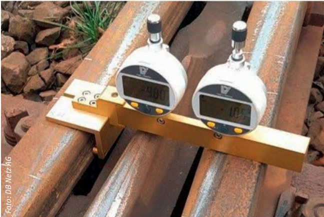
FFT-Set zur Ermittlung der Fahrflächenabsenkung
