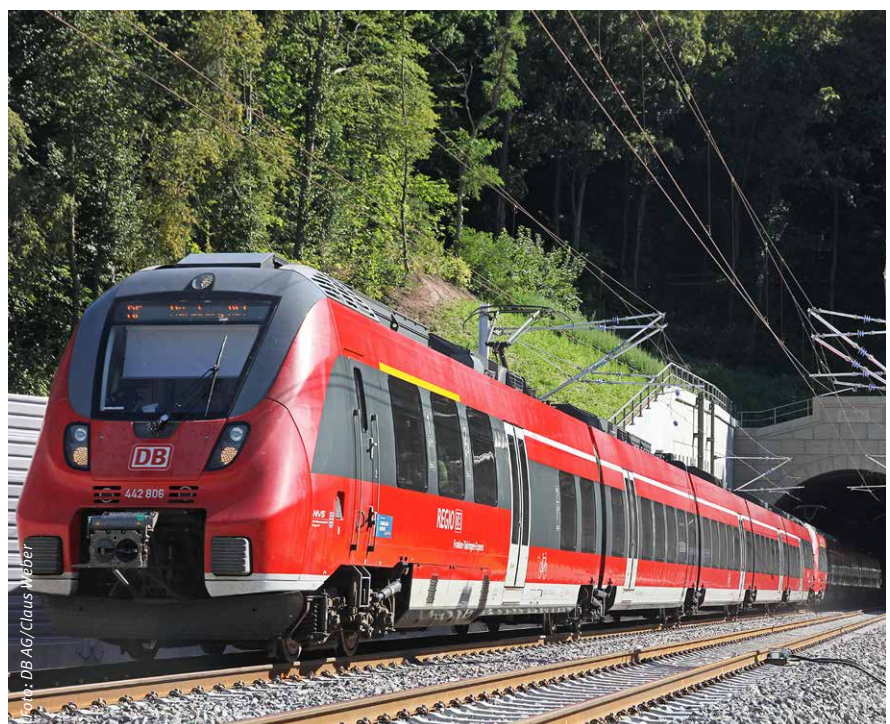
Triebwagen der Baureihe ET 442 (Talent 2) bei der Ausfahrt aus dem Burgbergtunnel in Erlangen
