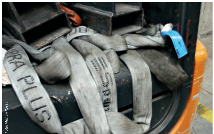
Abbildung 5: Rundschlingen werden unsachgemäß unter Stahlprofilen aufbewahrt. Sie sind der Benutzung zu entziehen und müssen überprüft werden.
