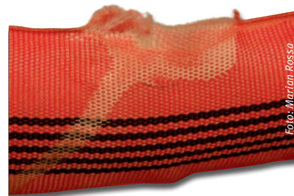
Abbildung 9: Beschädigung der Ummantelung durch aggressive Chemikalie
