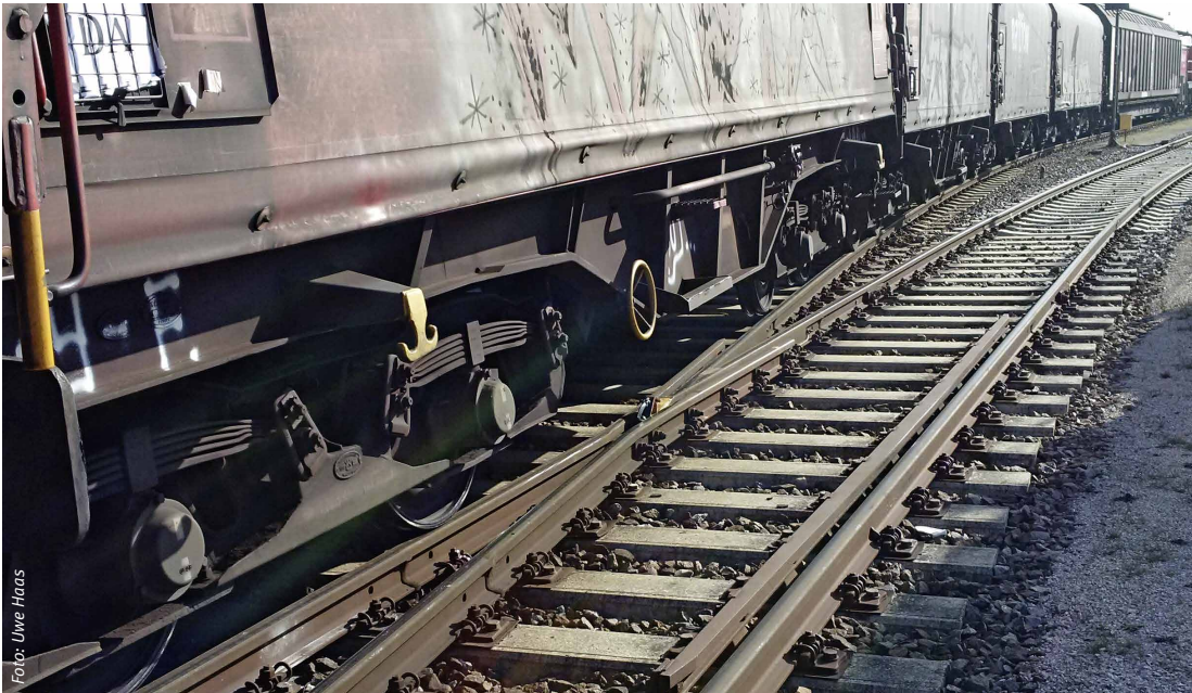
Abbildung 11: Bildliche Dokumentation einer Entgleisung bei einer geschobenen Rangierfahrt
