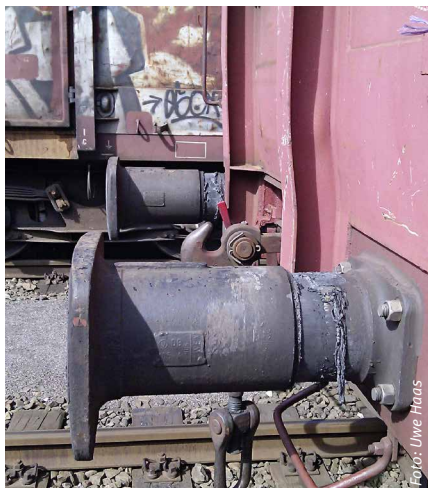
Abbildung 6: Der Zustand der Zug-, Stoß- und Bremsvorrichtungen ist zu untersuchen
