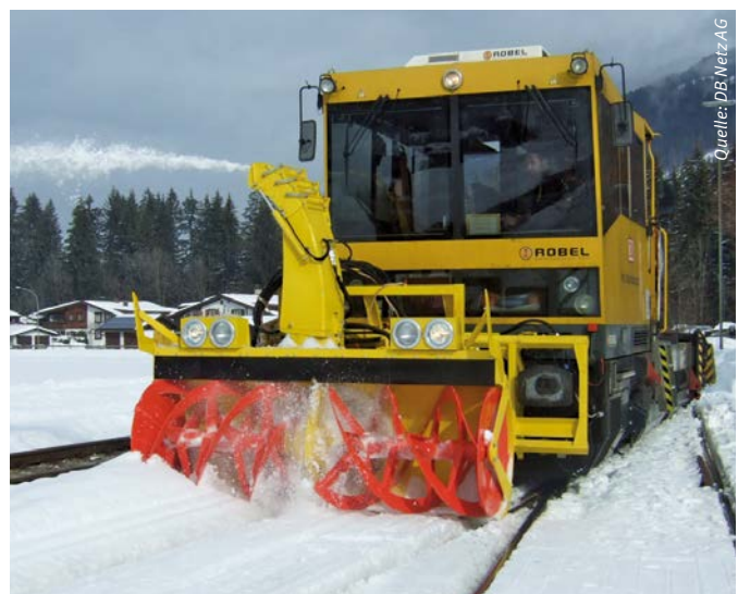
Bamowag mit Schneefrästechnik
