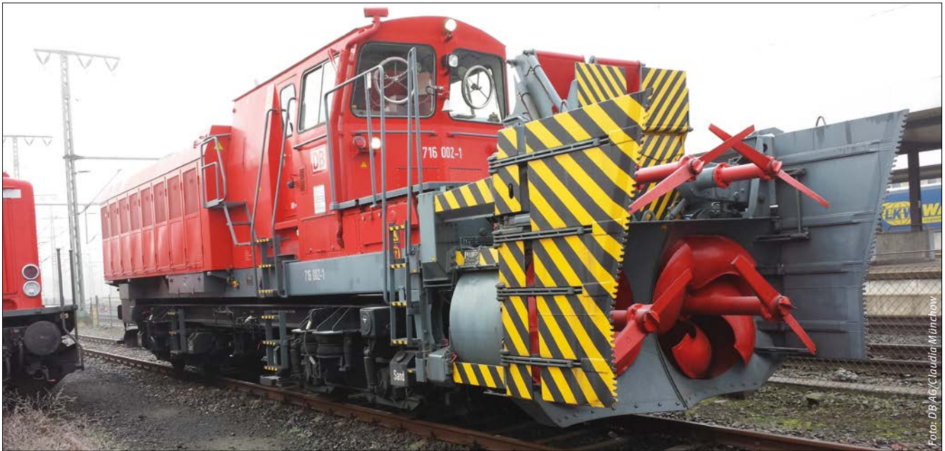
Selbstfahrende Schneeschleuder BR 716
