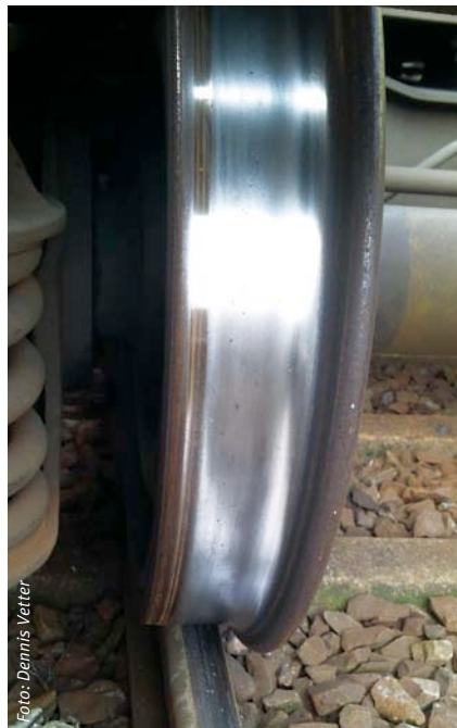
Abbildung 4: Lauffläche Radsatz V-BKS
