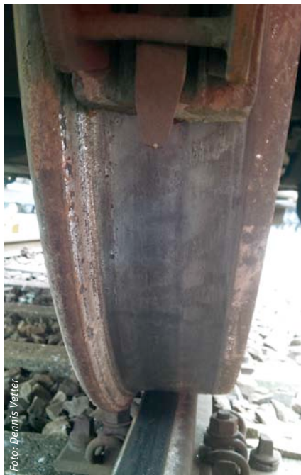
Abbildung 3: Lauffläche Radsatz GG-Sohle
