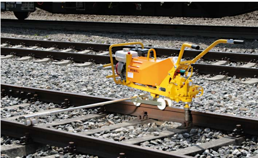
Abbildung 1: Schraubmaschine, kann nicht von einem Beschäftigten alleine getragen werden
