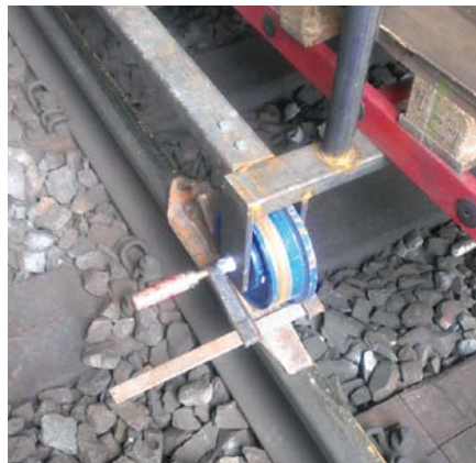
Abbildung 9: Links unzulässige Bremsmittel von selbst hergestellten Rollwagen, rechts zulässige Bremse einer schienenfähren Leiter
