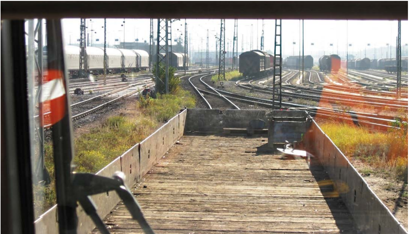
Abbildung 5: Sichteinschränkung des Triebfahrzeugführers bei einem geschobenen Güterwagen
