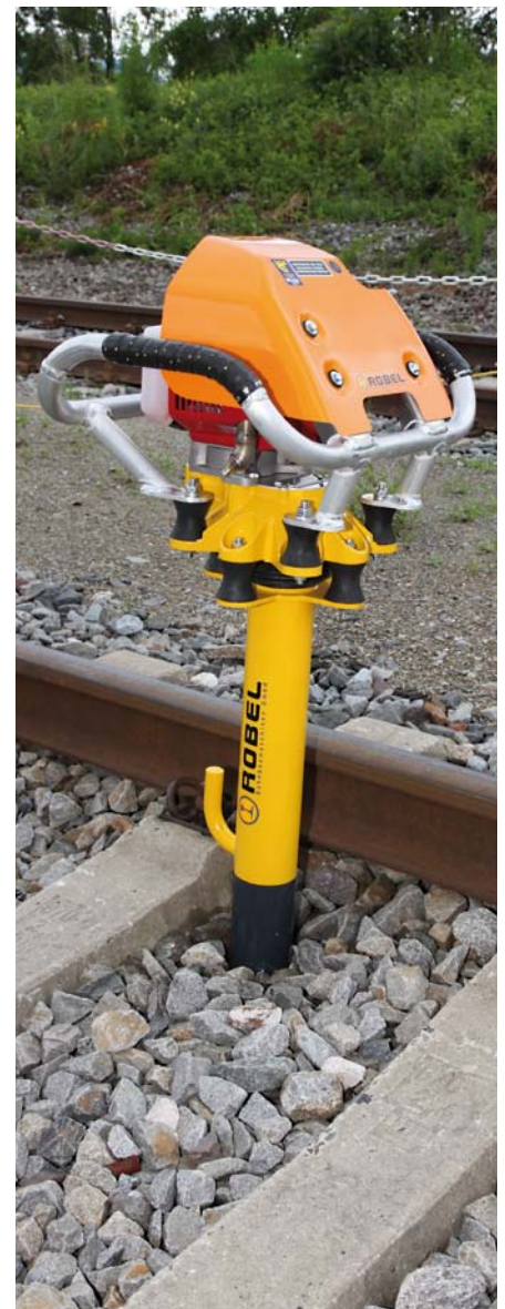
Abbildung 3: Kraftstopfer, greift in den Oberbau ein
