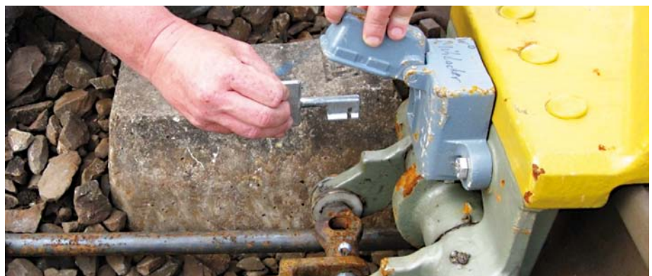
Abbildung 8: Schlüssel aus entnommenem Weichenschloss wird in Gleissperrenschloss eingeführt. Nach Entsperren des Schlosses kann die Gleissperre geöffnet werden
