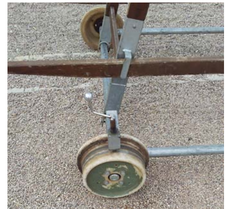
Abbildung 9: Links unzulässige Bremsmittel von selbst hergestellten Rollwagen, rechts zulässige Bremse einer schienenfähren Leiter
