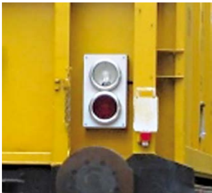
Abbildung 2: Weißes Licht an einem Güterwagen bedarfsweise einschaltbar
