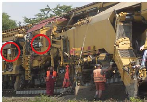
Abbildung 2: Messung der Richtcharakteristik im Rahmen der Projektierungen der Maschinenwarnung
