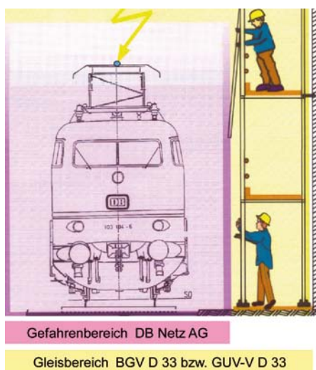
Abbildung 1: Beispiel zum Gleisbereich: Beim Hantieren mit Gerüstrohren neben dem Gleis besteht die Gefahr, in den durch Druck- und Sogwirkungen gefährdeten Bereich hineinzugeraten oder den Schutzabstand zu unter Spannung stehenden Teilen der Fahrleitungsanlage zu unterschreiten. Der Gleisbereich umfasst in diesem Fall auch die Arbeitsplätze der Gerüstbauer. Bei der DB schließt der Gleisbereich den Gefahrenbereich ein.
