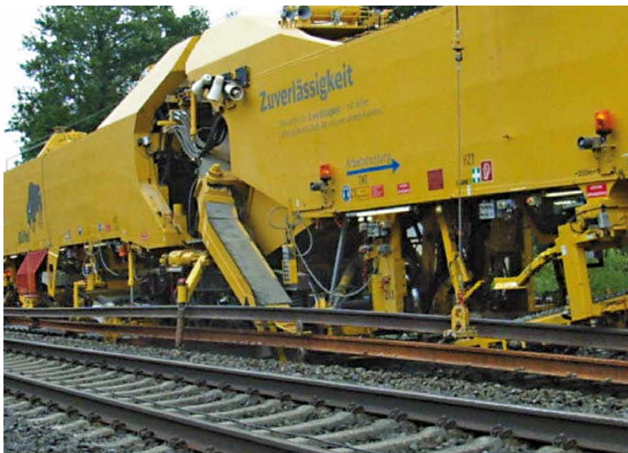
Abbildung 3: Warnsignalgeber eines maschineneigenen Warnsystems an einer Bettungsreinigungsmaschine.
