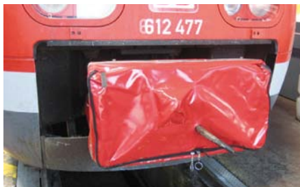
Abbildung 1: Geschlossene Kupplungsschutzhaube, der Metallrahmen ist mit der Schaku verschraubt (Foto: DB Regio/Jürgen Büttner)
