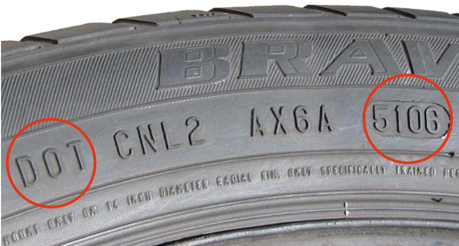
DOT-Kennzeichnung auf der Seitenwand des Reifens
