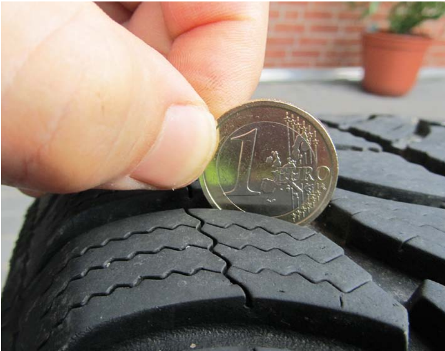
Wenn der Goldrand einer 1 Euro-Münze nicht mehr zu sehen ist, ist das Profil noch mindestens 4 mm tief
