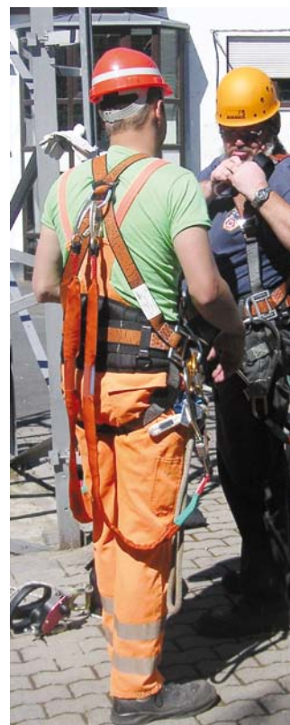
Abbildung 3, unten rechts: PSA gegen Absturz mit zwei Falldämpferseilen.
