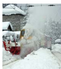
Unser Titelbild: Selbstfahrende Schneesleuder der Baureihe 716 001-3 auf der Strecke Freilassing – Berchtesgaden. Foto: DB AG/Thiel.
