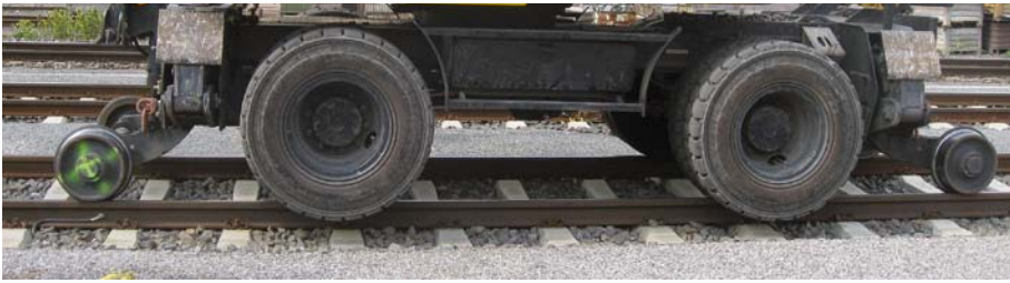
Abbildung 2: Unterwagen eines Zweiwegebaggers mit Gummirädern (Straßenräder) zum Beschleunigen und Bremsen des Fahrzeugs auf den Schienen sowie vordere und hintere Schienenführungseinrichtung
