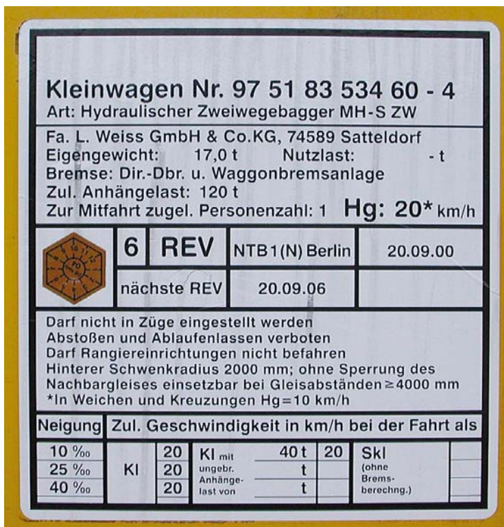
Abbildung 3: Anschriftentafel eines nicht DB-eigenen Fahrzeugs
