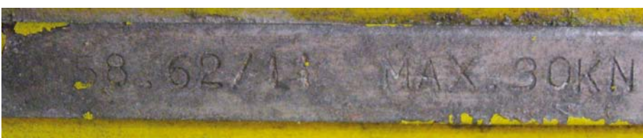
Abbildung 10: Kuppelstange mit Typenschild
