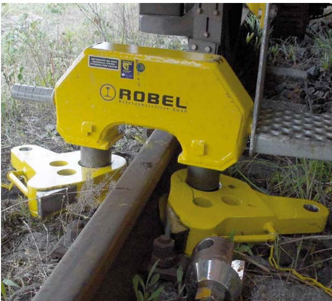
Abbildung 5, oben: Spannvorrichtung des Schienenziehgerätes
