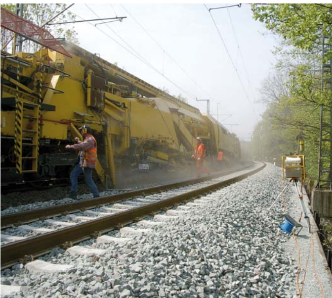
Abbildung 9: Arbeitsplätze an der Räumkette einer Planungsverbesserungsmaschine. An dieser Stelle werden maximale Störschallpegel erreicht.
