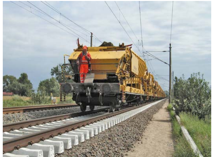
Abbildung 11: Schwere, geschobene Versorgungsfahrt bestehend aus Bunker-Schüttgutwagen.
