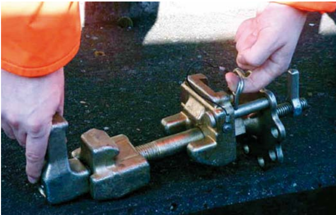
Schritt 1: Federstecker entfernen. Handrad bis zum Handgriff zurückdrehen.
