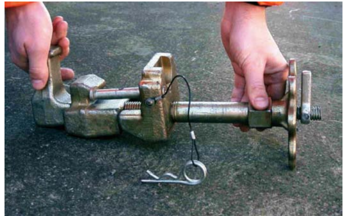
Schritt 3: Gewinderohr mit Mutter durch Drehen nach links bis an das Handrad herandrehen und Klemmstücke auseinander schieben; Gewinderohr drehen. HV in den Schienenfuß einhängen und rechtwinklig zur Backenschiene ausrichten.
