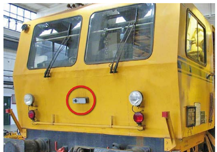
Abbildung 5: Stopfmaschine mit stirnseitig angebrachter Kamera.
