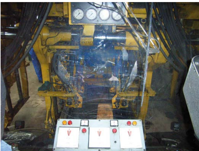
Abbildung 3, unten: Vom Bedienplatz in der Stopfkabine besteht Sicht auf die Stopfaggregate, jedoch keine Sicht auf den Fahrweg vor oder hinter der Maschine.
