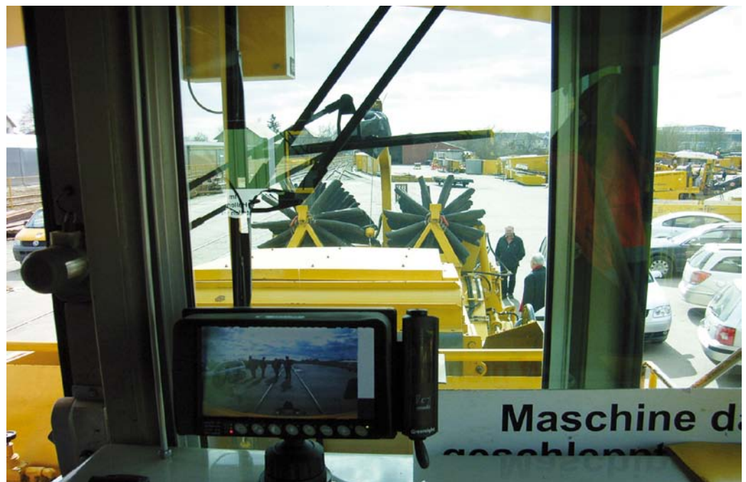
Abbildung 9: Während die Personengruppe vor der Schotterplaniermaschine durch die Kabinenfenster nicht erkennbar ist, ist sie durch die Kamera an der Pufferbohle im Monitor sichtbar.
