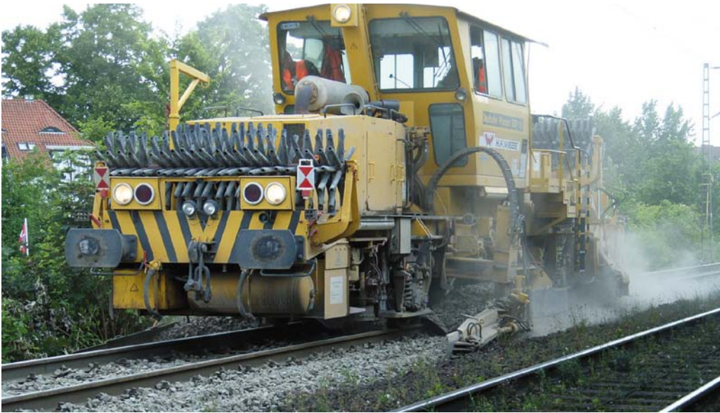
Abbildung 6: Schotterplaniermaschine: Arbeits-Fahrkabine etwa mittig angeordnet, Kehrbürsten werden mitgeführt.
