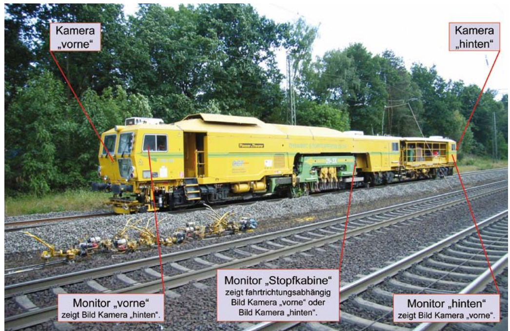
Abbildung 4: Anordnung von Kamera-Monitor-Systemen, um für Arbeits-Fahrbewegungen von jeder Bedienposition aus die direkte oder indirekte Sicht auf den Fahrweg der Stopfmaschine zu ermöglichen.
