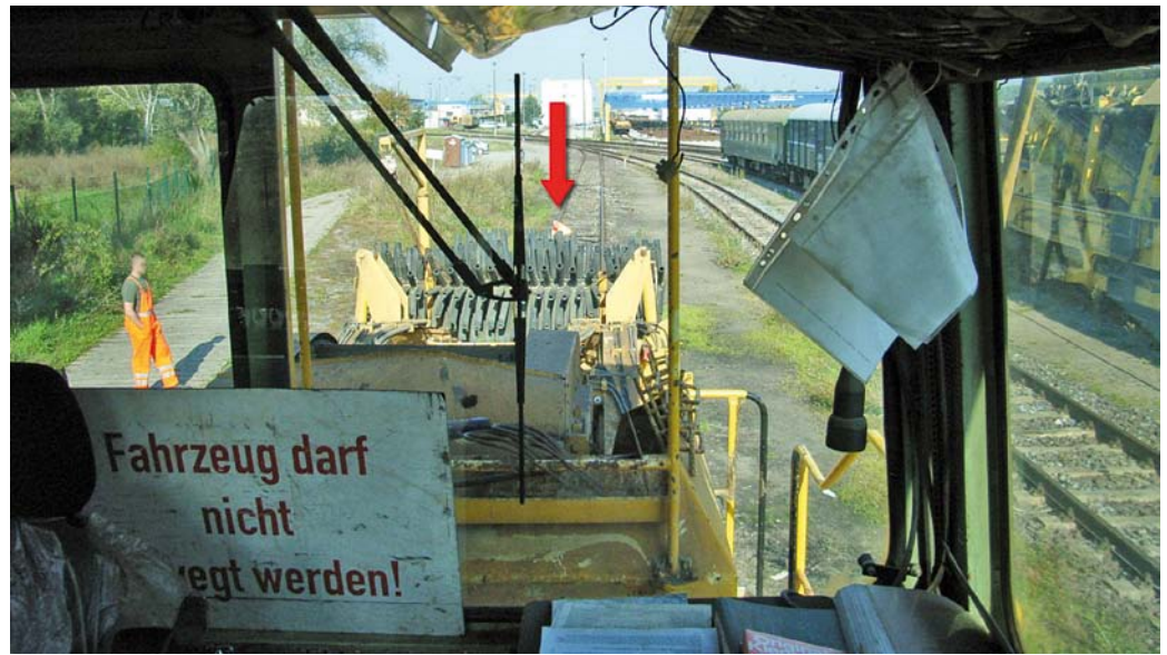
Abbildung 8: Sicht aus den Kabinenstirnfensern einer Schotterplaniermaschine auf einen Mitarbeiter in gebückter Position ca. 15 m hinter der Maschine.
