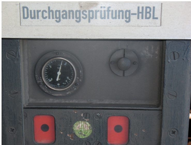
Abbildung 6: Druckknopf für die Durchgangs- prüfung der Hauptluftbehäl- terleitung (HBL).
