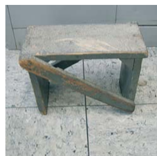
Abbildung 2, unten: Selbst gebauter Holztritt (Kippsicherheit fehlt). Der Tritt sollte nicht mehr benutzt werden.
