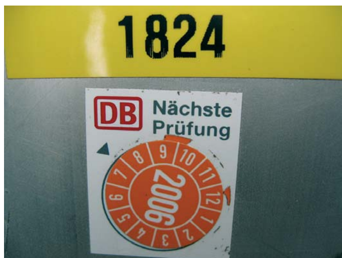
Abbildung 9: Prüfplakette mit Angabe des nächsten Prüftermins, hier z.B. Juli 2006 (7/2006) und der Inventar-Nummer der Leiter.
