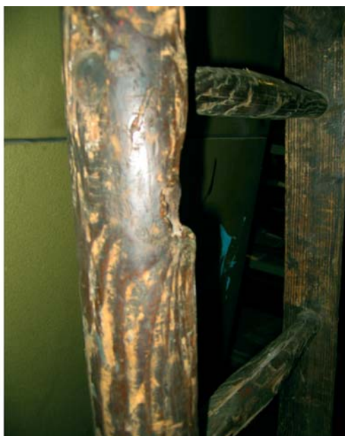
Abbildung 1, links: Holzleiter mit Schäden am Holm und Risse in den Sprossen. Diese Leiter ist unverzüglich der Benutzung zu entziehen.
