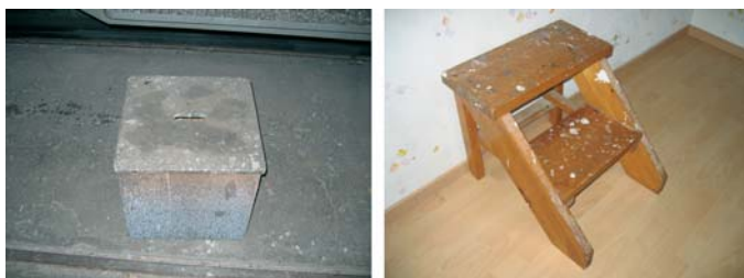
Abbildung 14: Aufstieghilfen, ungeeigneter Tritt und ungeeigneter Treppentritt. beiden Fällen ist eine ausreichende Kippsicherheit nicht gewährleistet.
