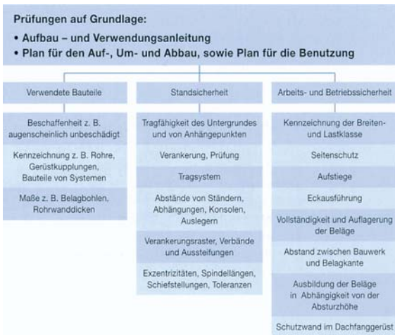
Abbildung 3: Prüfung von Arbeits- und Schutzgerüsten nach § 10 BetrSichV.
