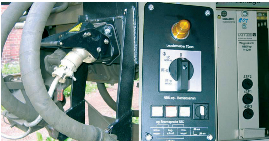
Abbildung 5: Unten links – eine der beiden Steckdosen an der Fahrzeugfrontseite (hier Lok BR 143). Unten Mitte – Wahlschalter für NBÜ-ep-Betriebsarten im Führerraum (hier Lok BR 143). Unten rechts – Wagenkarte NBÜ/ep (hier Doppelstockwagen der BA 785).
