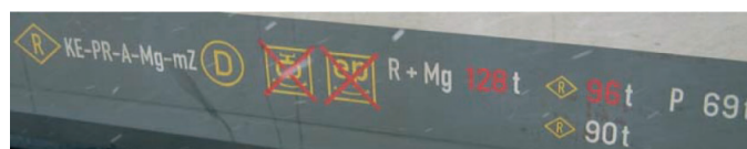
Abbildung 1: Bremsanschrift an einem Doppelstockwagen mit durchgekreuzten Symbolen der NBÜ/ep. Abbildung 2: Bremsanschrift an einem Triebzug der BR 642. Abbildung 3: Neue Bremsanschriften – links Tzf BR 143, rechts Doppelstockmittelwagen der BA 785.
