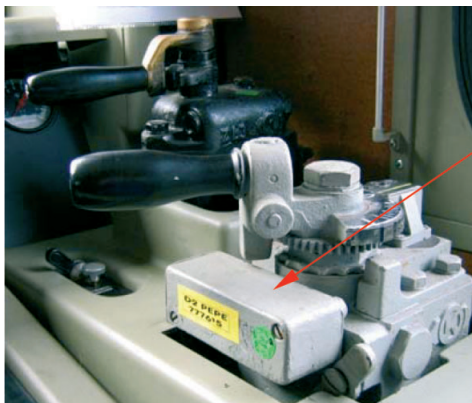
Abbildung 4: Unten – Angepasstes Führerbremventil der Bauart D2 PEPE – markant ist die Verkleidung der zusätzlichen Schalter für die Fahrtstellung, Füllstoßstellung und Schnellbremsstellung.
