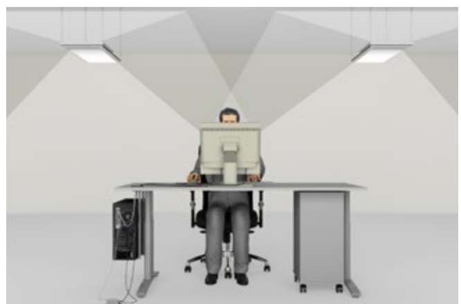
Abb. 46 Beispiel für Direkt-/Indirektbeleuchtung
