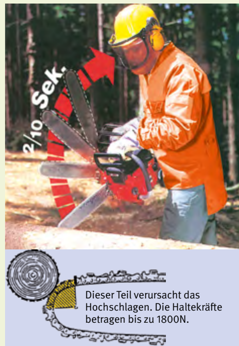
Abb. 26 Hochschlagen der Motorsäge
