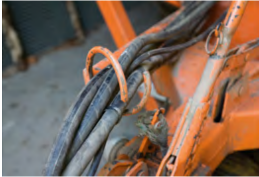
Abb. 42 Hydraulische Leitungen richtig verlegen
