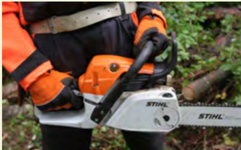
Abb. 25 Richtiges Halten einer Motorsäge
