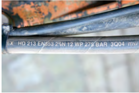
Abb. 43 Beschriftung auf der Schlauchleitung
