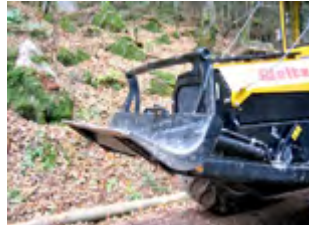
⑦ Polterschild für gefahrloses Holzpoltern
