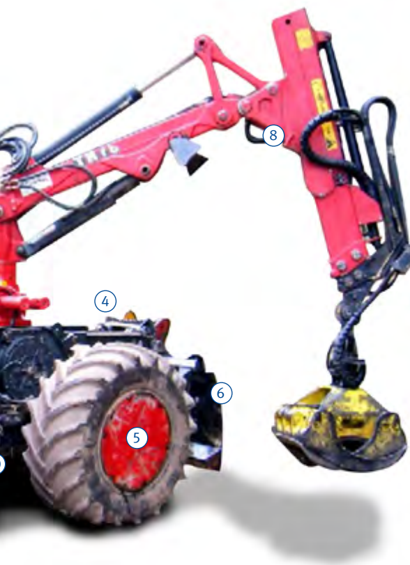
⑥ Bergstütze zum sicheren Abstützen
