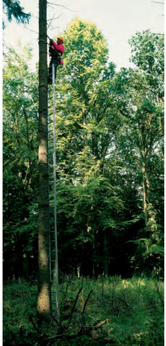
Abb.111 Einsatz der Steigleiter
