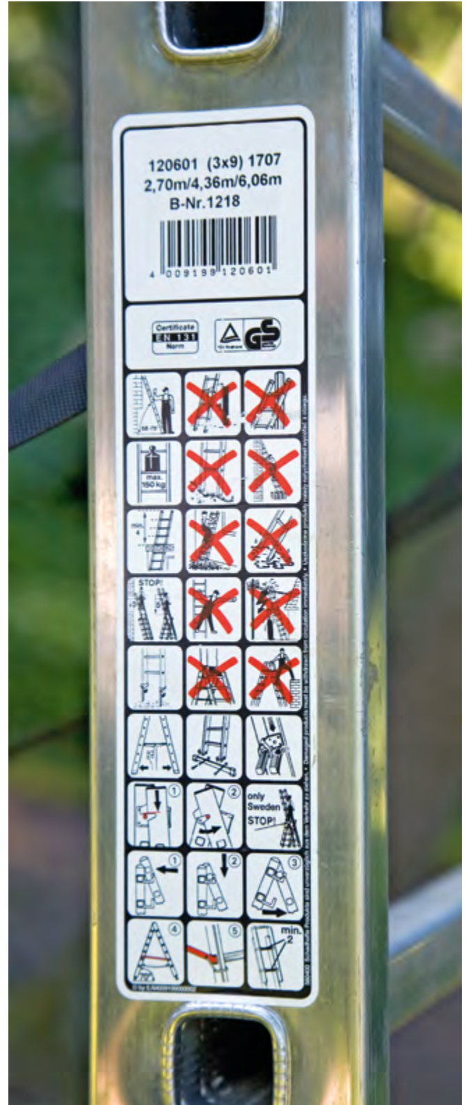
Abb. 35 Kurzbedienungsanleitung in Form von Piktogrammen
