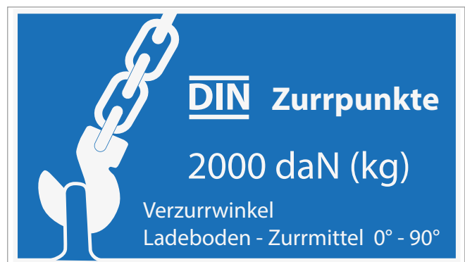
Abb. 54 Kennzeichnung eines Zurpunktes bei größeren Fahrzeugen
