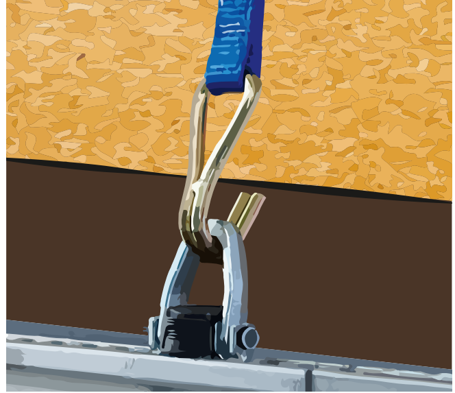
Abb. 53 Verstellbarer Zurpunkt für leichte Ladung
