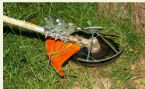
Abb. 31 Spezielles Grasschneideblatt mit Schutz
