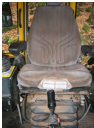
⑨ Fahrersitz schwingungsgedämpft zur Vermeidung von Ge- sundheitsschäden durch Schwingungen und Stöße
