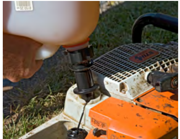
Abb. 24 Betanken mit Sicherheits-Einfüllstutzen
