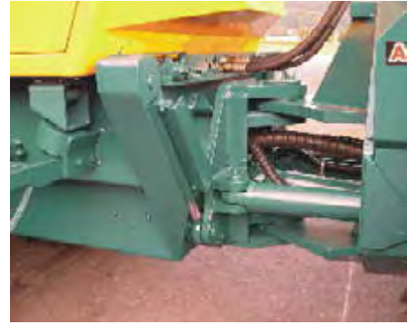
Abb. 44 An Fahrzeugen mit Knicklenkung ist der Aufenthalt im ungesicherten Knickbereich verboten.
