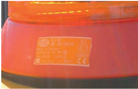
Bild 2 Alle Warnleuchten bzw. Blinkleuchten müssen eine Bauartgenehmigung nach § 22 a StVZO haben (kenntlich gemacht durch ein Prüfzeichen)
